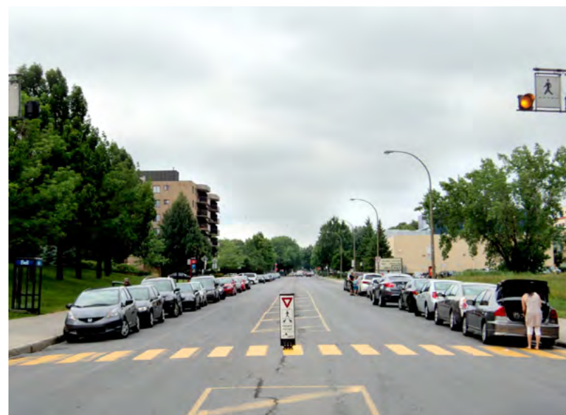
Photo 8b : Passage pour piétons sans contrôle : panneau signalant une amende à payer, feux clignotants accompagnant le pictogramme
