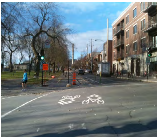
Photo 14 : Feux simultanés pour piétons et pour usagers de la piste cyclable
