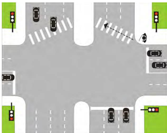
Croquis 3a : Traversée en deux temps, trajectoire non rectiligne, risque qu'une voiture empiète dans le passage pour piétons
